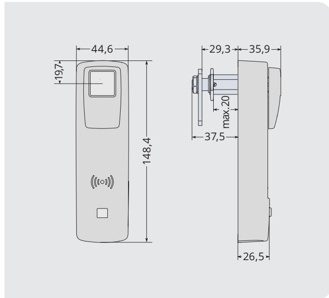
La cerradura electrónica de gabinete pKT tiene una cerradura de leva estándar integrada y garantiza una fácil instalación. La cerradura para armario pKT se puede utilizar en todos los gabinetes y taquillas con un grosor de puerta de hasta 20 mm. La electrónica diferencia entre estados cerrados y abiertos.
