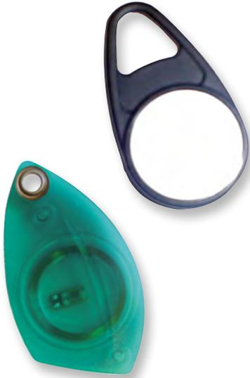
On compte dans les procédés de lecture sans contact les transpondeurs actifs et les transpondeurs passifs. La technologie de lecture RFID passive, préconisée par primion, fait partie des procédés les plus répandus. A l'inverse des transpondeurs actifs, les transpondeurs passifs n'ont pas besoin de batteries, mais tirent leur énergie du signal haute-fréquence des appareils de lecture.
